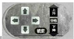
点击展示区的面板按钮,可以通过方向按钮 键来控制搬运车的各种操作。
