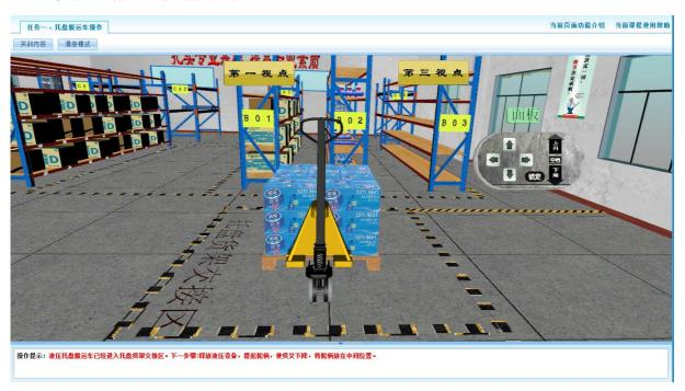
点击下降按钮 , 释放液压设备,使货叉下降, 要想再次托起货物, 再点击上升 按钮, 调整舵柄就可以再次托起货物了。
